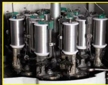
Schermo realizzato con lega tenace in alluminio-magnesio (AlMg). La trecciatura è operata tramite macchine 16 spole, MOLTO EFFICACE CONTRO I DISTURBI IMPULSIVI.
